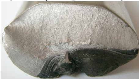
Typický únavový lom, hliníková slitina (zdroj fotografie [6])
