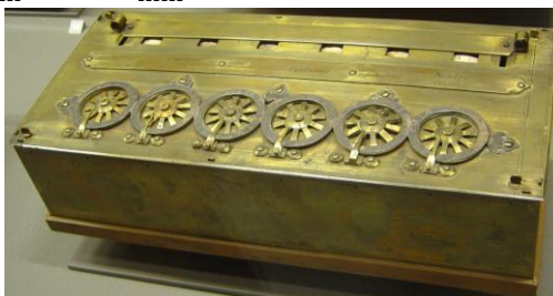
Portrét Blaise Pascala a jeho mechanický počítací stroj Pascalina (zdroj obrázků internet)
